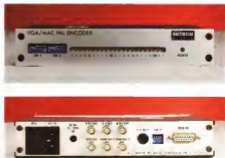
Sul frontale i 22 banci di dip-switch e dei 22 trimmer multipli per la regolazione dei parametri di ricostruzione dei segnali PAL; sul retro la dotazione di connettori per l'alimentazione esterna.
